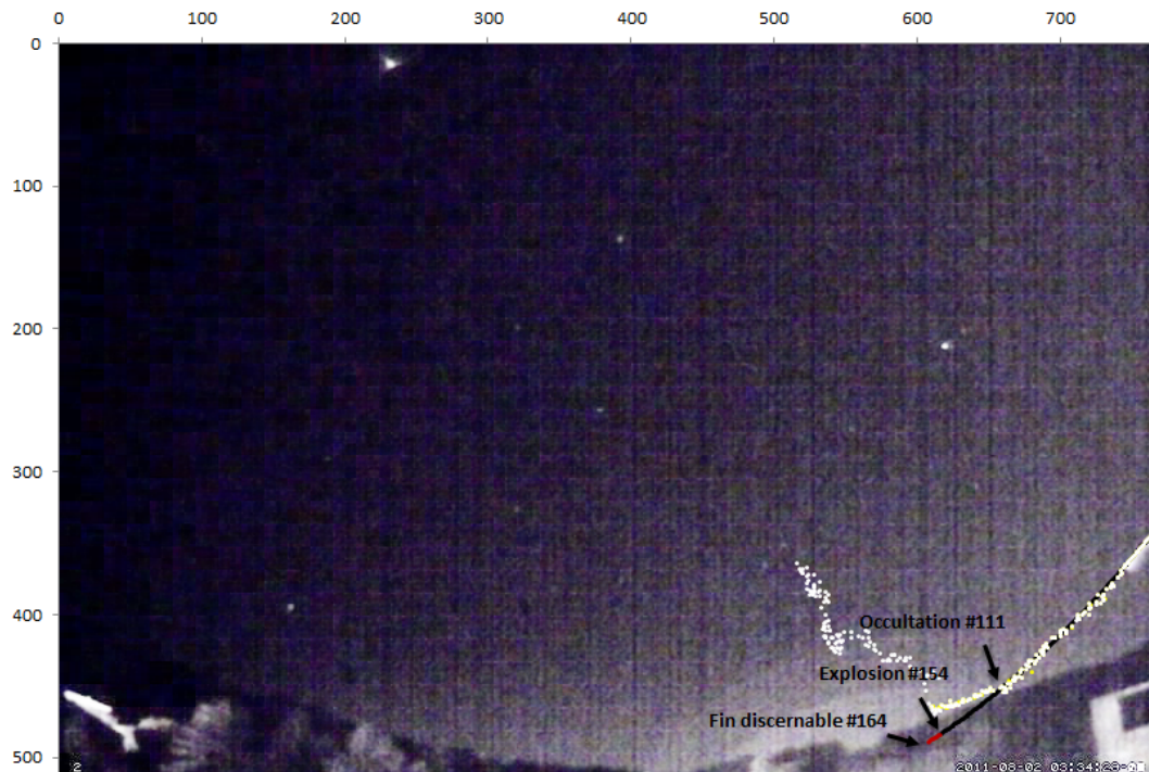
Fig.5 Superposition de la trajectoire repérée puis interpolée par une équation
