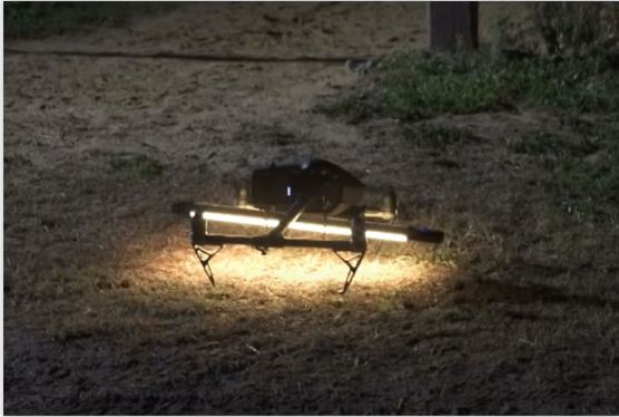
Le drone au sol, la disposition de la rampe LED est bien visible - Source
