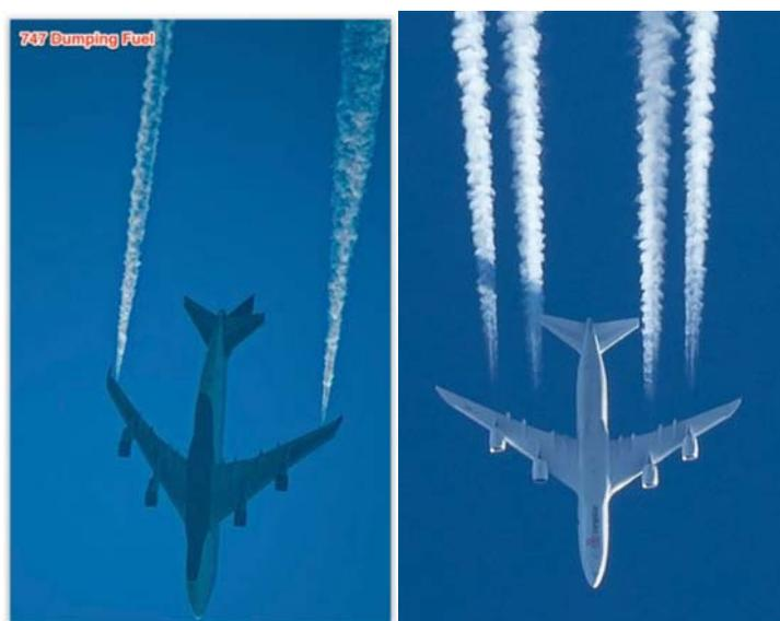
*Boeing 747 : à gauche traînées de délestage, à droite, traînées de condensation normales*
