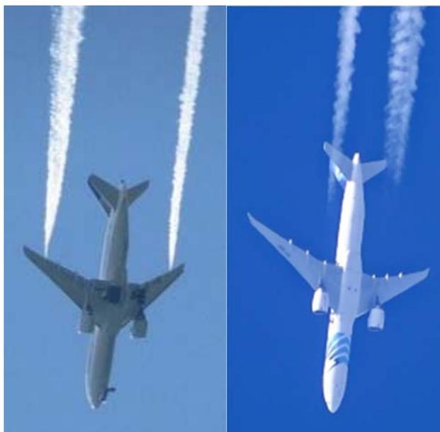
*Boeing 777 : à gauche traînées de délestage, à droite, traînées de condensation normales*
