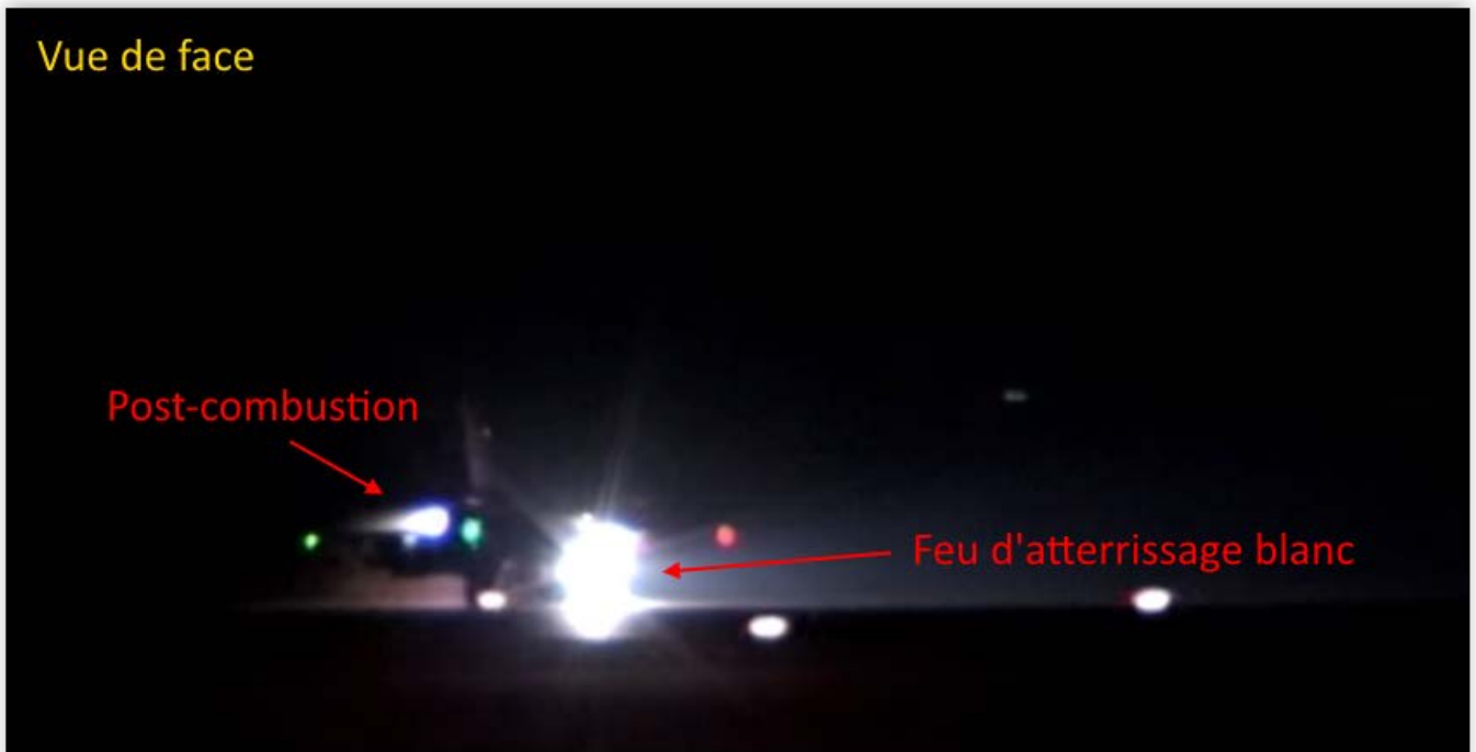
Rafale au décollage, le feu de navigation arrière n'est pas visible, seul l'est le feu d'atterrissage
