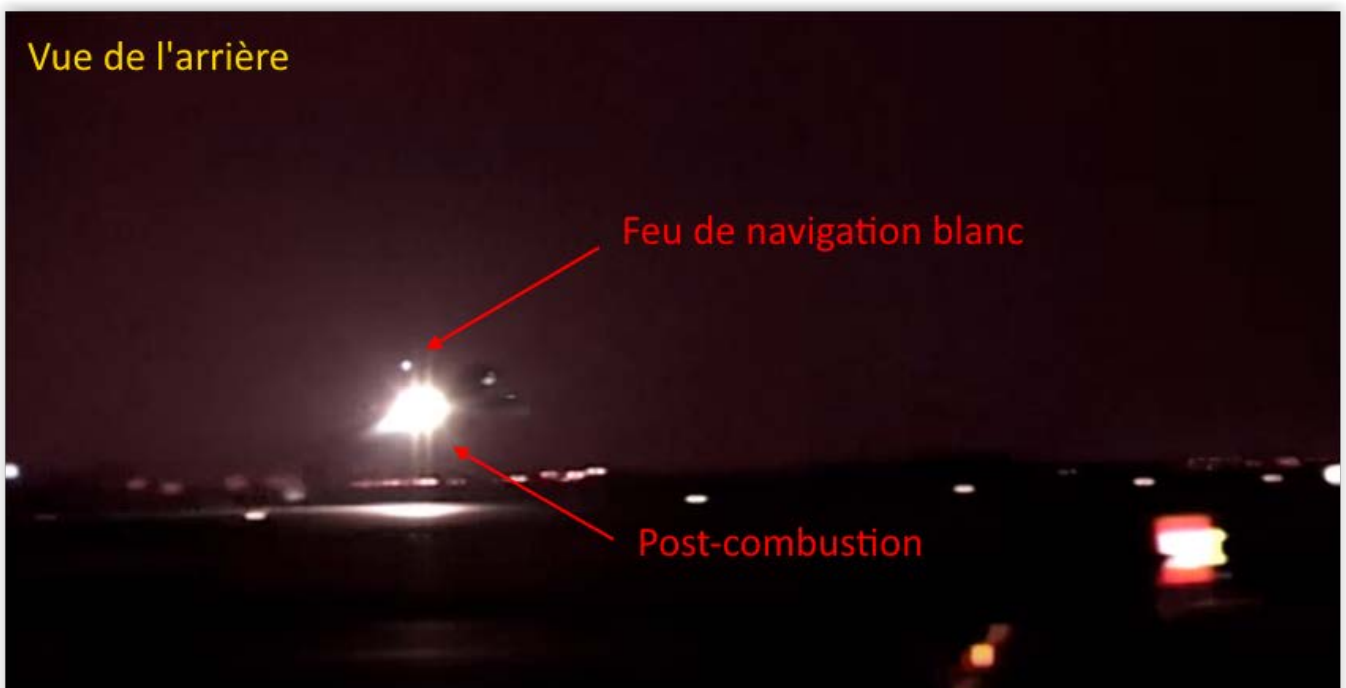
Peu de temps après, le même Rafale. Le feu d'atterrissage n'est plus visible. Le feu de navigation le devient.
